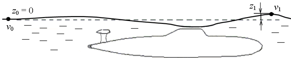
Рис. 3.2. К определению скорости на свободной поверхности над подводным объектом
