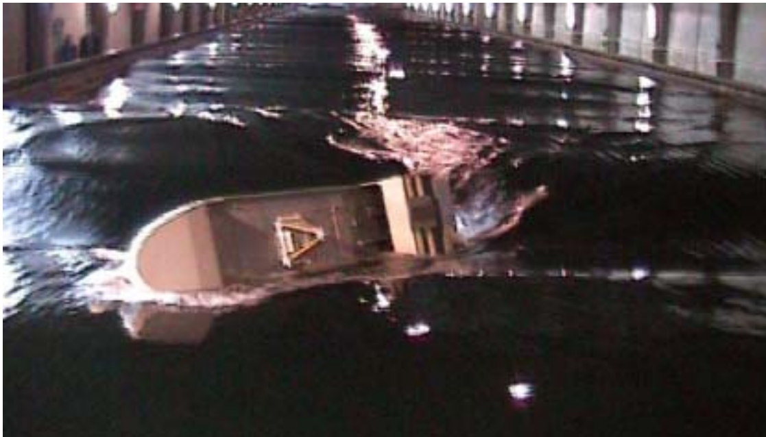
Рисунок 3.61. Опрокидывание модели судна при брочинге
