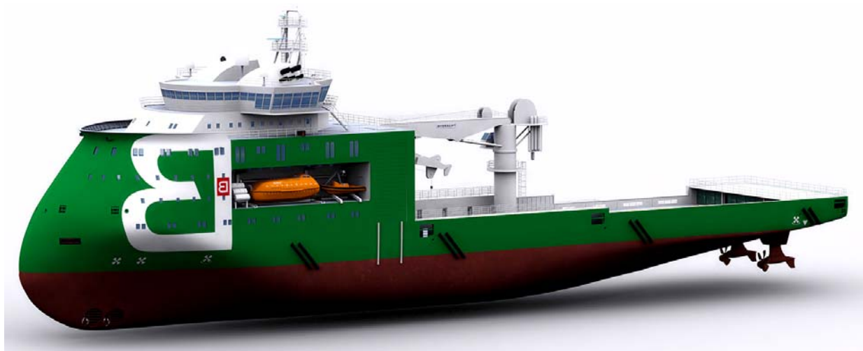
Рис. 3.28. Судно «Bourbon Orca» с завалом борта в носовой оконечности
