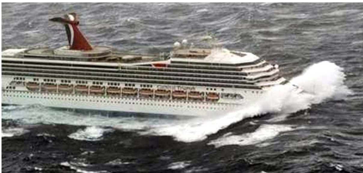
Рисунок 3.52. Зарывание судна носом в волну
