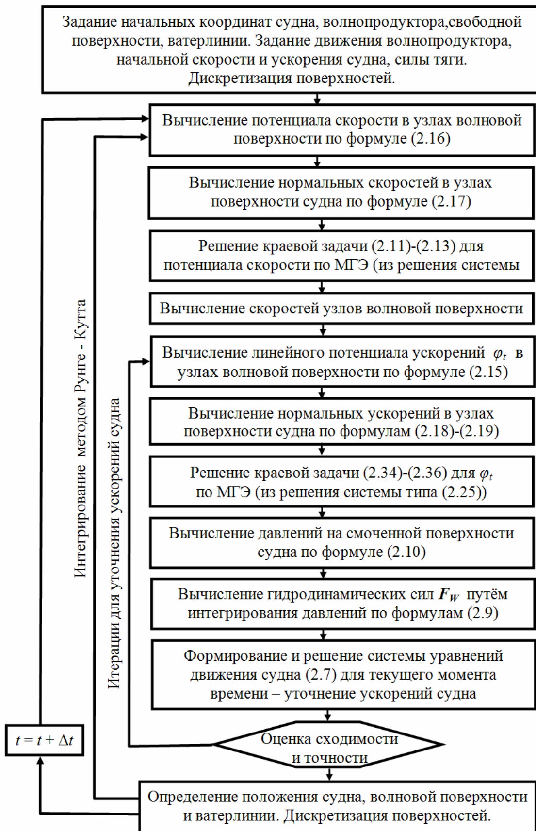
Рисунок 2.5 Блок-схема решения задачи о качке судна
