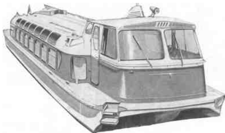
Рис. 7.4. Глиссирующее речное пассажирское судно «Заря»
