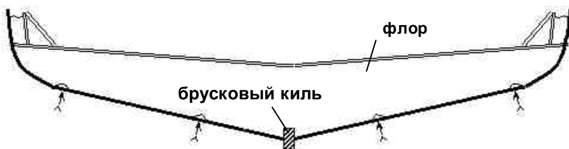
Рис. 1.8. Поперечный разрез днища малого судна
