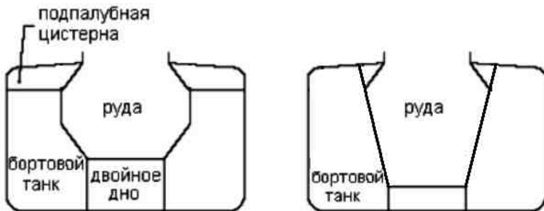
Рис. 4.13. Типовые миделевые сечения рудовозов
