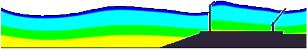
Рис. 5.40. Накат волн на преобразователь с двумя вертикальными стенками, имеющими шарнирные верхние части
