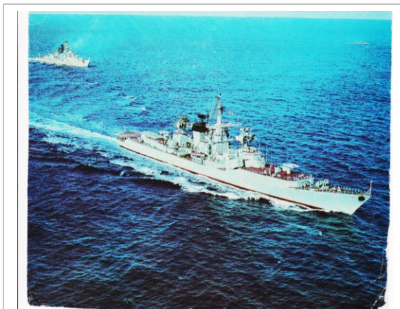
Рис. 1. На фотографии видно, что начало носовой системы волн сдвинуто в корму
