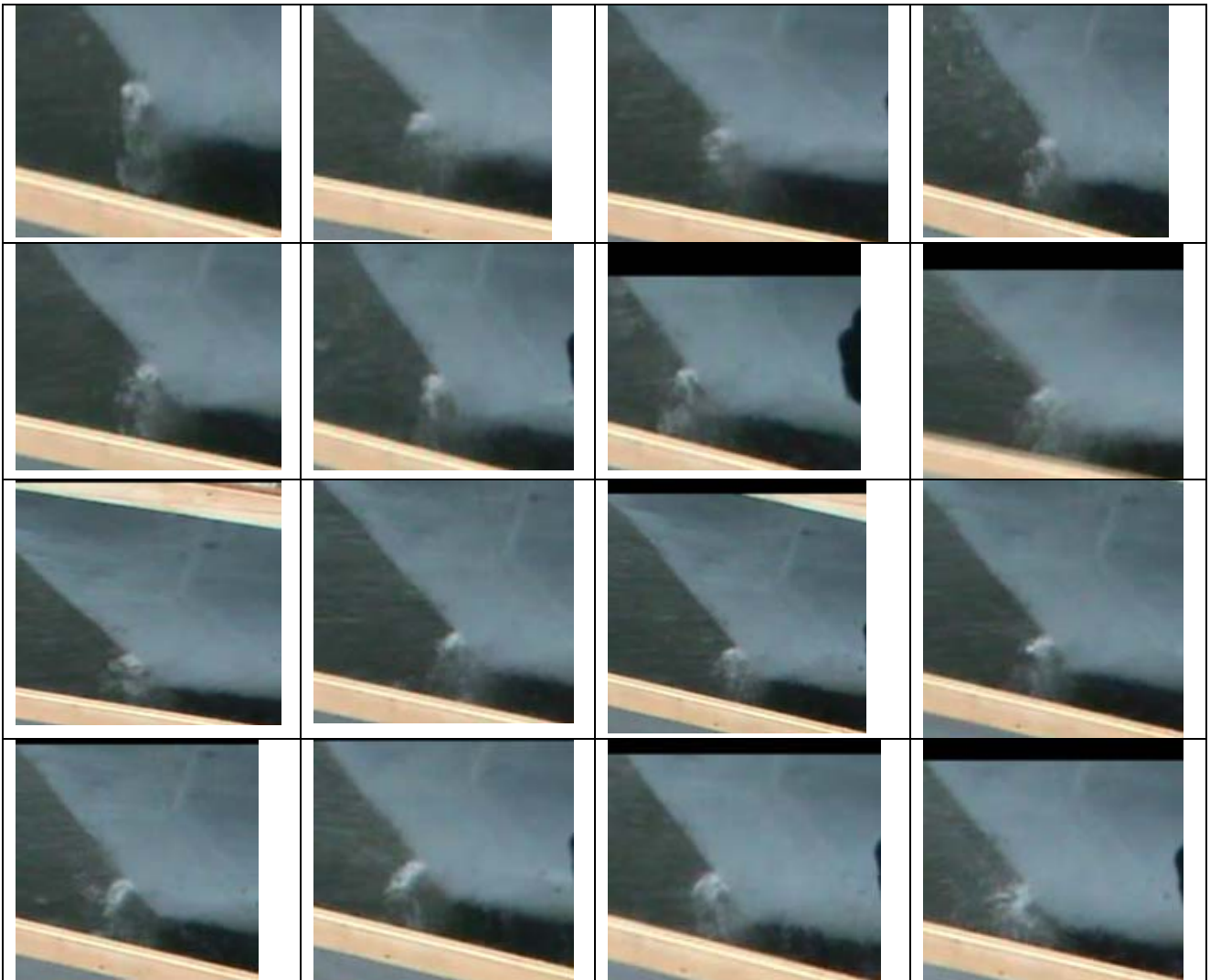
Рис. V. 11. Отбрасывание струи в месте пересечения форштевня с поверхностью воды. (снимки сделаны с периодом 6 сек, который не совпадает с периодом пульсаций воды)
