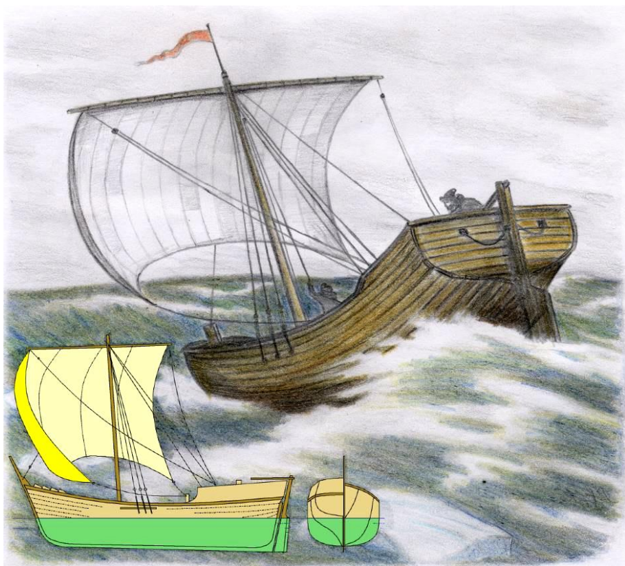
Рис.11. Рыболовное судно русских поморов. Образец корпуса, допускающего активное маневрирование в штормовом море, что необходимо для ухода в укрытие от реальной штормовой опасности. При этом обводы корпуса учитывают особенности штормового плавания по волне под управлением штормовых парусов и навесного руля
