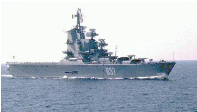
Рис. 7. Крейсер «Москва» имеет обводы в форме двойного клина и сильный развал бортов вдоль всего корпуса корабля.
