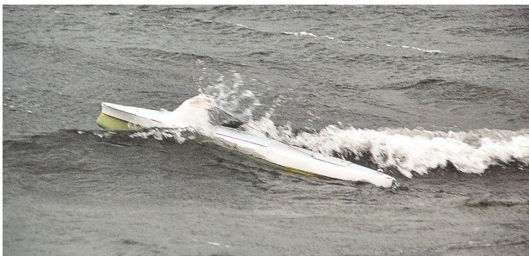
Рис. 46. Мореходные испытания гидрофизического модуля на обрушающейся штормовой волне при ветре порядка 10-12 м/с. Модуль преодолевает косым курсом гребень обрушающейся волны и практически не отражает ее от своего корпуса
