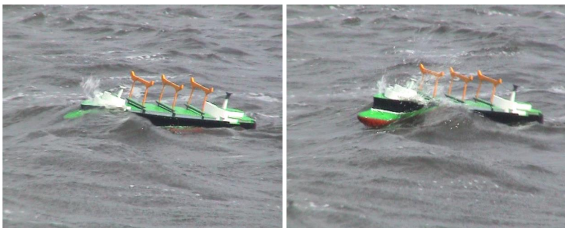
Рис. 56. При встрече с крупной штормовой волной, тяжелый носовой бульб разрушает монолитность фронта, перенося точку приложения сил всплытия ближе к средней части корпуса
