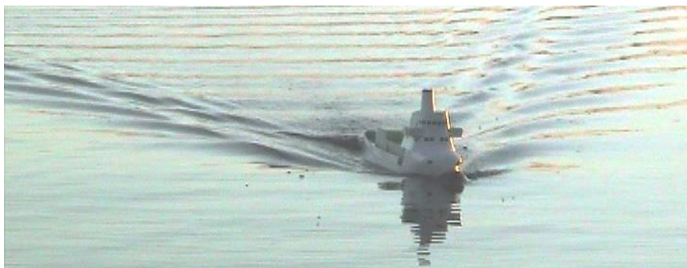
Рис. 3. Характерная картина волнообразования при равномерном и прямолинейном движении судна по спокойной поверхности воды. ( \lambda/L ) = 0,5; V=13 узлов, За кормой отчетливо просматривается система поперечных корабельных волн, ограниченная треугольником свободных расходящихся волн.
