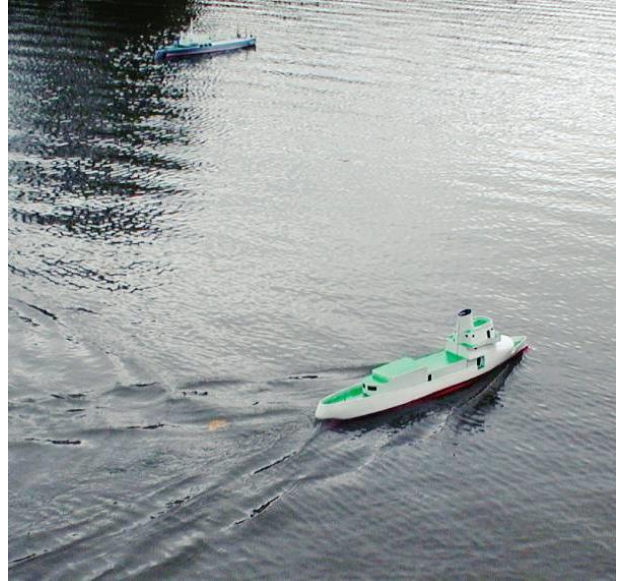
Рис. 61. По характеру корабельного волнообразования корпус модели может быть признан вполне оптимальным
