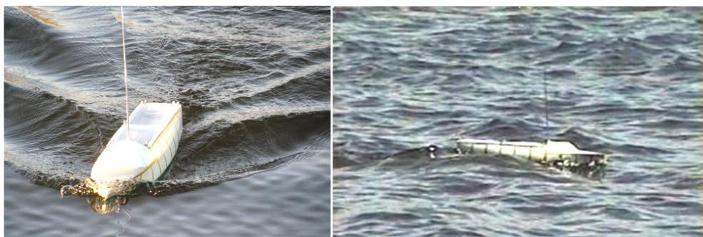
Рис. 34. Оптимизированный по килевой качке корпус не имеет ходового дифферента на большой скорости на тихой воде (фото слева). На полном ходу по крупной волне динамическая стабилизация корпуса по дифференту не нарушается, и вся энергия волн трансформируется в вертикальную качку корпуса (в качестве движителя на опытовой модели установлено жесткое машущее крыло)
