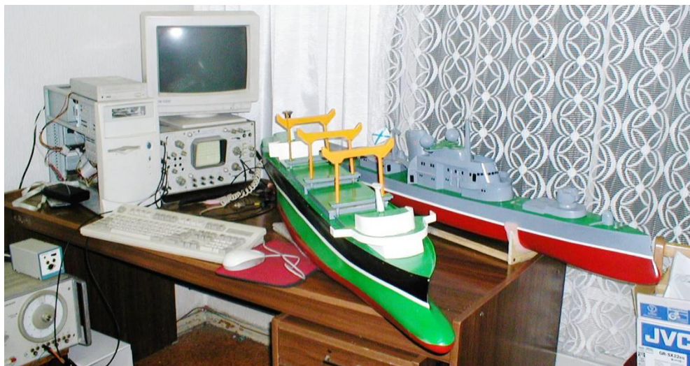
Рис. 11. Модель универсального транспортного судна и модель патрульно-гидрографического корабля на достроечном столе. Устанавливается аппаратура радиуправления и тестируются измерительные датчики для регистрации штормовой качки и ходкости моделей, имеющих реконструированные исторические обводы корпусов.
