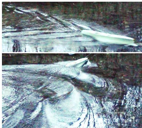
Рис. 26. Проверка влияния уменьшения полноты скуловых обводов на форму корабельного волнообразования. На верхнем рисунке скорость соответствует Fn \approx 0,3 , на нижнем Fn \approx 0,7 . По-видимому, в этом эксперименте принципиально изменился характер образования расходящихся корабельных волн.
