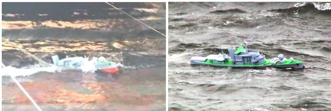
Рис. 54. Эксперименты в опытном бассейне (слева) и на озере Тунайча (справа) с самоходной моделью быстроходного корабля. Округлый корпус не разрушает гребни крупных волн, что позволяет поддерживать высокую скорость хода. Испытания на регулярном волнении показали практически полную гидродинамическую компенсацию бортовой качки на крупном волнении.
