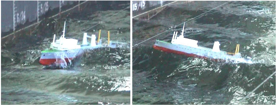
Рис. 66. Рыболовный траулер в условиях жестокого волнения. Испытания самоходной радиоуправляемой модели не выявили опасных режимов штормового плавания. Несмотря на малую мощность двигателей, траулер сохраняет способность двигаться и маневрировать на любых курсах относительно волнения
