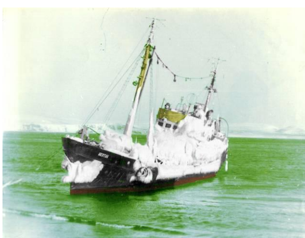
Рис. 16. Обледенение среднего рыболовного траулера «Нептун». Прячась от ледяных брызг, траулер вышел на прибрежное мелководье, а при отливе накренился, став килем на морское дно.
