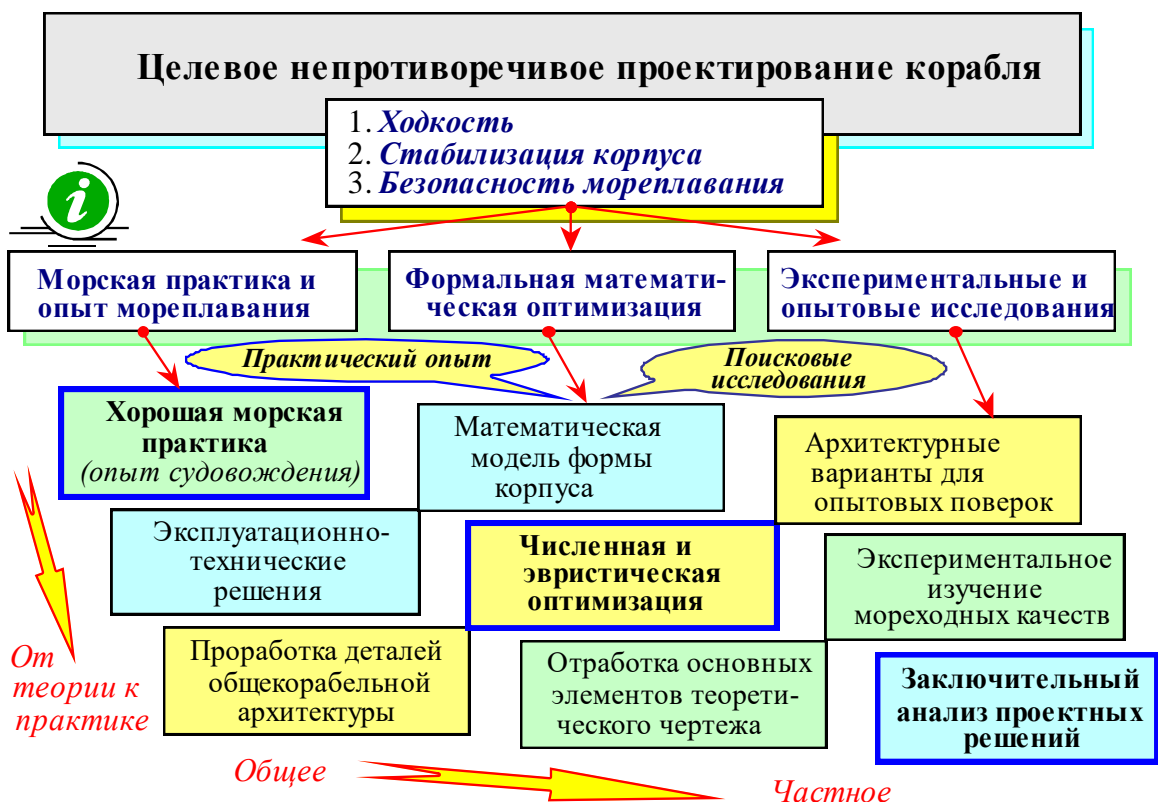
Рис. 1. Логическая матрица в форме троичного иероглифа поискового проектирования схеме «сверху-вниз»: от обобщенных теоретических предпосылок к частным инженерно-техническим решениям. Столбцы матрицы попарно связаны исторически поверенными решениями задач морской практики (слева) и современными достижениями в области корабельной гидромеханики (справа). По строкам образуются уровни этапов адаптации инженерных решений в ограничениях технологических возможностей судостроения, изначально адаптированных к региональным условиям для достижения эффективности мореплавания в сложных, штормовых и ледовых условиях дальневосточных морей.
