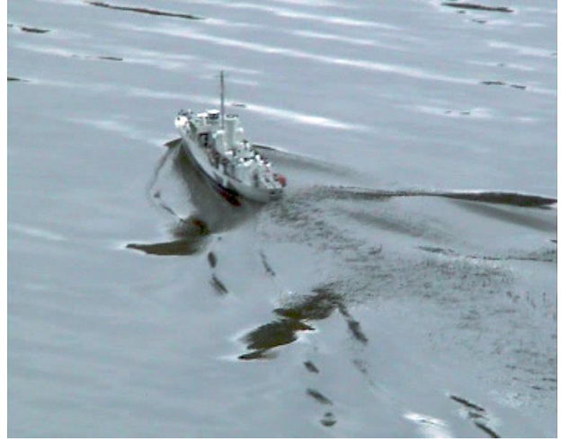
Рис. 16. Вблизи корпуса корабля происходит сложение и усреднение энергии всех высокочастотных проявлений корабельного волнообразования, с последующим излучением только некомпенсированной волновой энергии
