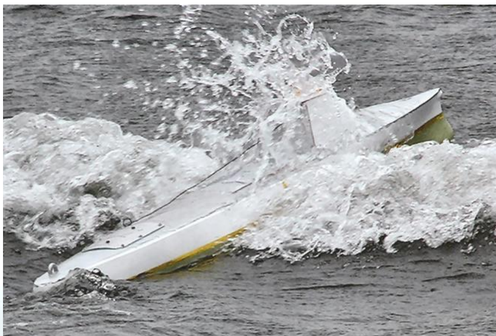
Рис. 30. Остановка судна на встречной волне, и полное реверсирование потока от гребных винтов и набегающего потока на рулях
