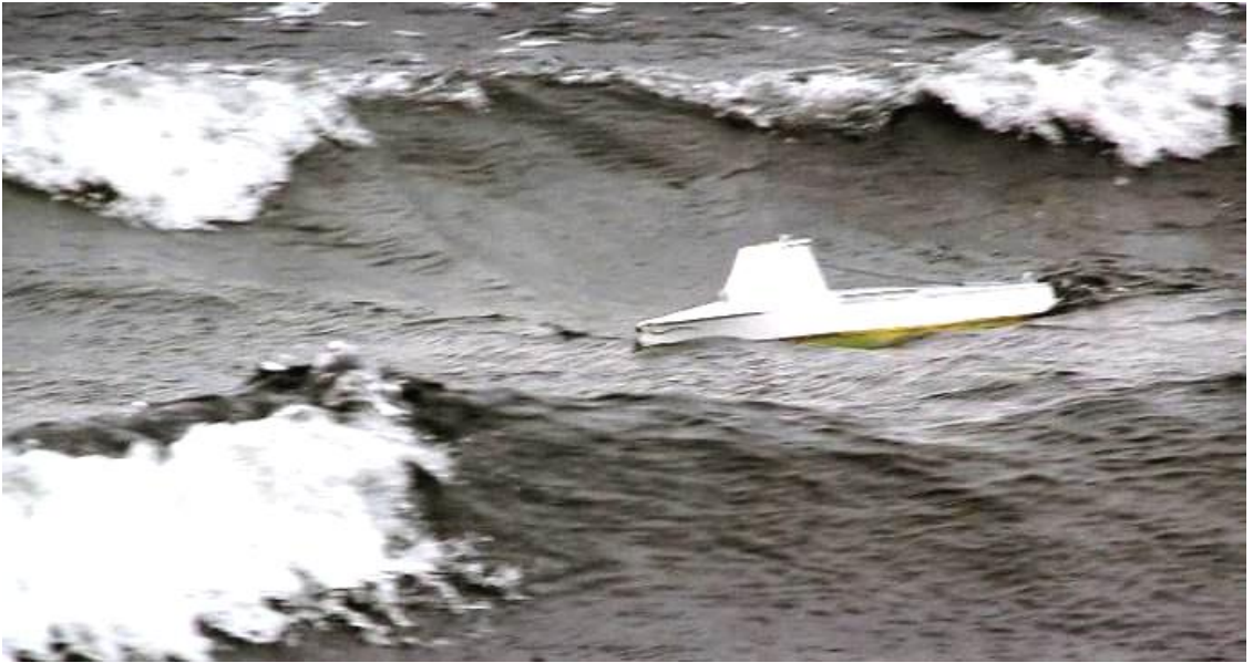
Рис. 28. Испытание телеуправляемой модели корабля в условиях прибойного волнения. При выходе на мелководье протяженность фронтов штормовых волн вытягиваются, при этом крутизна гребней значительно возрастает. Любой режим маневрирования в таких условиях, особенно если обводы корпуса специально не оптимизировались для штормового плавания, становится чрезвычайно опасным
