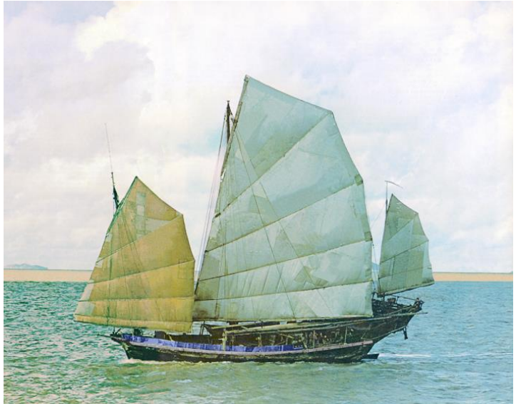
Рис. 1. Китайская джонка – пришедшее из глубины веков совершенное парусное судно с превосходной мореходностью. Непотопляемость этих крупных судов, длиной порядка 40÷50 м, обеспечивается водонепроницаемыми поперечными переборками. При движении в узкостях или на безветрии, на Востоке издревле используются плавниковые весла, единственно не теряющие работоспособности при плавании в условиях постоянного волнения дальневосточных морей
