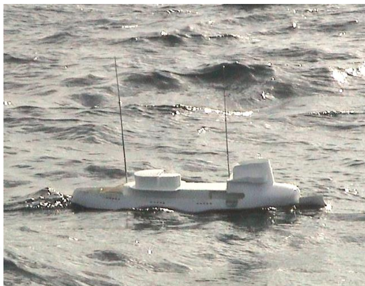
Рис. 58. Округлый корпус и низкие палубы судна уменьшают интенсивность всех видов штормовой качки на глубокой воде
