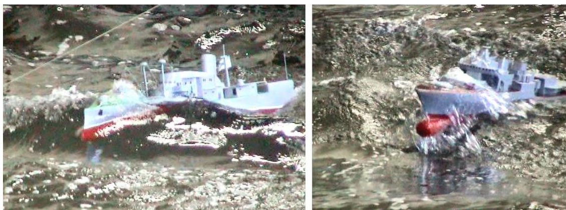
Рис. 31. Недопустимо, чтобы на курсе вразрез волны носовая часть корабля подвергалась чрезмерным силовым нагрузкам со стороны штормового волнения (справа). Это означает, что вместо подводного бульба и сильного развала носовых шпангоутов, корпус должен иметь подводный подрез форштевня и предельно минимальный объем надводного борта выше ватерлинии (слева)
