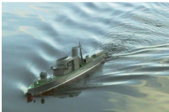
Рис. 51. Характер корабельного волнообразования. Носовая расходящаяся волна свободно отрывается, не затягиваясь под скулу корпуса с развитым носовым бульбом.
