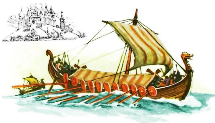
Рис.8. Лодья –парусно-гребное судно древних славян. Маневренность лодьи не хуже чем у египетских судов, что позволяло ходить по мелким российским речушкам и ходом преодолевать днепровские пороги. И все же мореходность этой речной лодьи, судя по летописям, допускала дерзкие походы на Черном море, которые не всегда заканчивались «победами» над штормовой стихией
