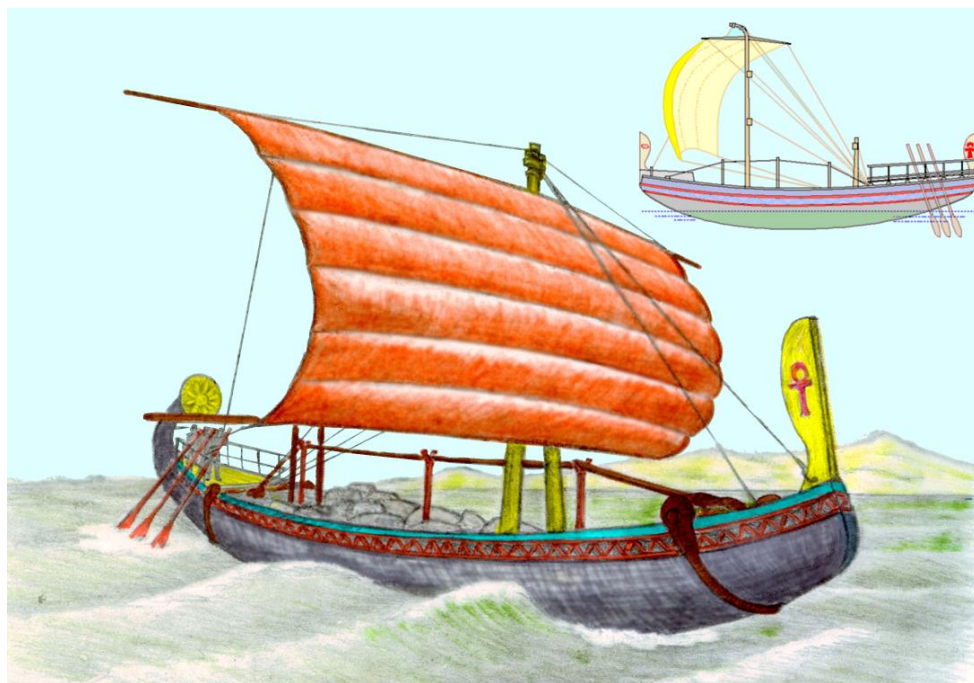
Рис.5. Египетское судно. Корпус судна приспособлен для речного плавания с частыми подходами к пологому необорудованному берегу. Плоское днище делает корпус очень поворотливым, может быть, даже излишне вёртким, что, кстати, при сильном изгибе килевой линии обеспечивает высокую рыскливость корпуса на резком речном волнении. Это уменьшает забрызгиваемость грузов внутри судна и позволяет уворачиваться от опасного заливания при жестких встречах с гребнями крупных волн
