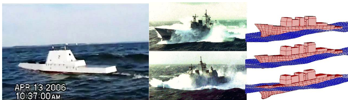
Рис. 32. Мореходные испытания корабля 21-века (DDG-1000, «Зумвальт») в США в открытом море (слева); численное моделирование динамики корабля на крупном волнении (справа); и наблюдение за кораблем на аналогичном штормовом волнении (в центре)
