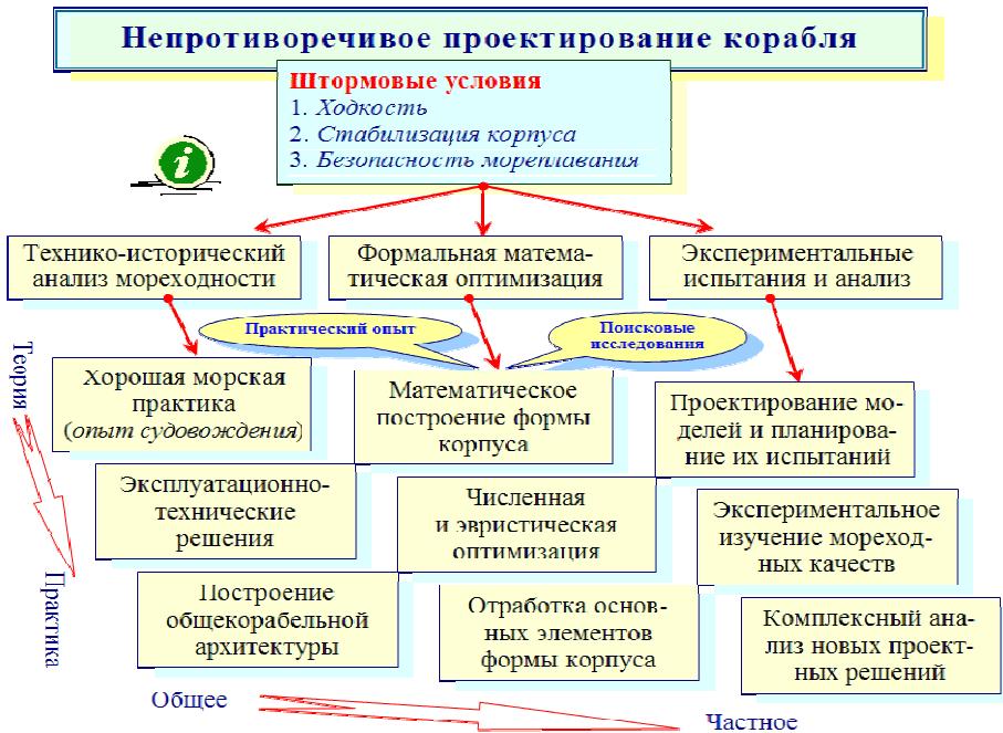
Рис. 1–а. Троичный иероглиф проекта по схеме «сверху-вниз»: от обобщенных теоретических предпосылок к частным инженерно-техническим решениям. Столбцы матрицы попарно связаны вариантами исторически поверенных методов морской практики (слева) и современных достижений в области корабельной гидромеханики (справа), что по строкам образует уровни этапов адаптации инженерных решений в ограничениях технологических возможностей судостроения
