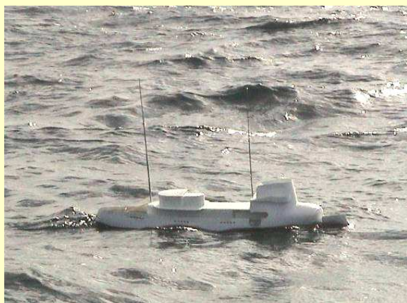
Рис. 7. Округлый корпус и низкие палубы судна уменьшают интенсивность всех видов штормовой качки на глубокой воде
