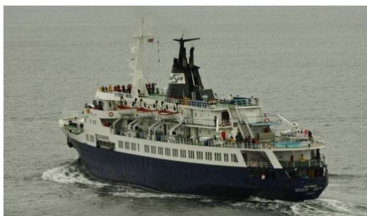
Рис. 1. Пассажирский лайнер «Любовь Орлова» без широкой транцевой кормы – обладает плавной качкой с прогнозируемой интенсивностью.
