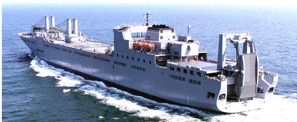
Рис. 3. Накатное судно с кормовой аппарелью, с промежуточным положением надстройки и машинного отделения (МО), с носовым бортовым лацпортом и мощными подъемными кранами
